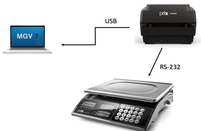
A Impressora Térmica com Memória Prix IT400M está apta para comunicar com o MGV 7 e as balanças da linha comercial: 3 Fit e 3 Plus.
