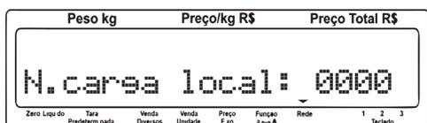
Tecla **Entra** e será exibido o número da carga de supervisão da balança (quando gerenciada pelo MGV 7) conforme tela a seguir:
