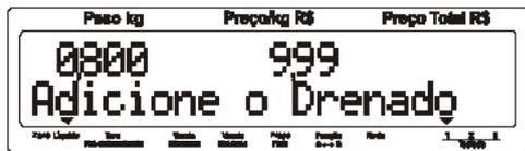
Com o display indicando o peso drenado, tecla
