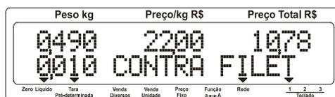
Tecla **Imprime** para efetuar a impressão com os dados da transação. Na etiqueta impressa, a tara predeterminada será indicada com as letras "**TP**" após o seu valor.
