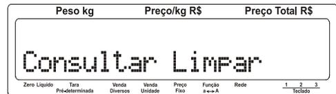
Utilize uma das três teclas , ou para selecionar a opção "Limpar" e em seguida tecele com "Limpar" piscando.
