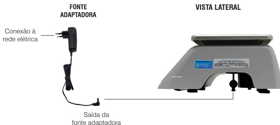
A recarga da bateria está iniciada. Durante o carregamento o display ficará apagado, ou seja, a balança só terá condições de funcionamento após a bateria atingir o nível mínimo de carga. Depois de atingir esse nível e com a balança ligada o indicador de nível da bateria presente no display "Preço Total" se acenderá gradativamente conforme a tensão. Após recarga completa, todos os níveis estarão acesos indicando o estado da bateria e irão se apagando proporcionalmente a diminuição da carga.
